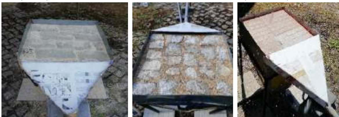
Fig. 60): pequeños cubos de granito (SCC), grandes cubos de granito (LCC), cuadrados de cemento (CQ), bloques de cemento rectangulares (RCB) y bloques de cemento tipo "mapa de Portugal" (BCMP).
