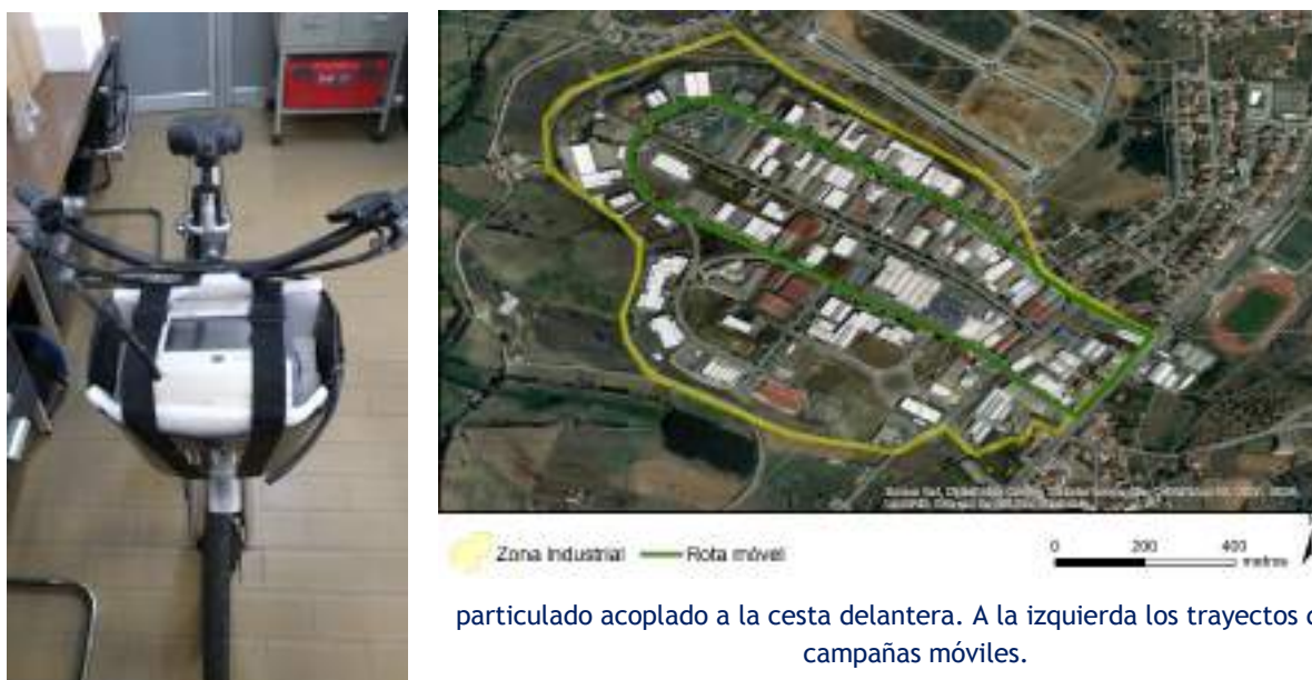
Fig. 37- Sistema de monitorización móvil. A la derecha se encuentra la bicicleta con el monitor de material
